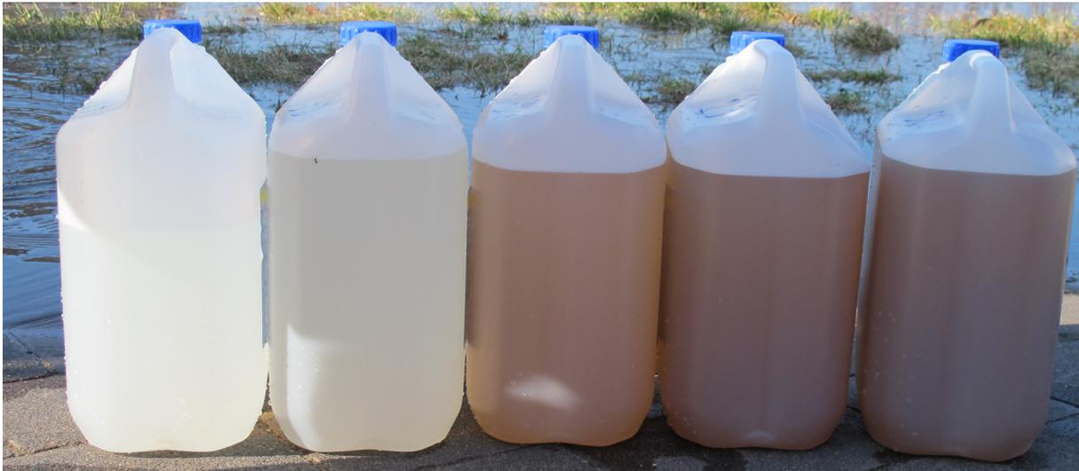
Bild 58. Spülwasserproben aus der Rohrleitungsspülung 7 in den Straßen 6, 11 und 2 zeitlich sortiert von links nach rechts.
