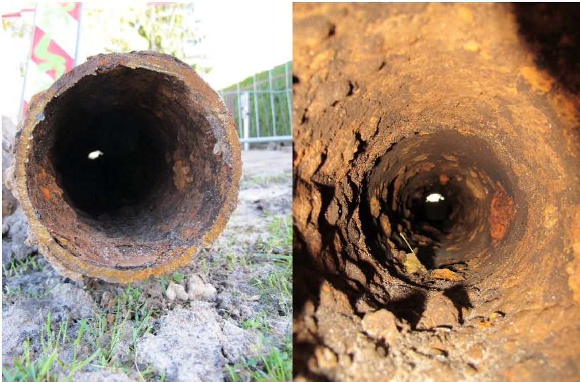
Bild 1. Fotografie einer ausgegrabenen Stahlleitung mit einem Innendurchmesser von 80 mm und Wandstärke 5 mm.
