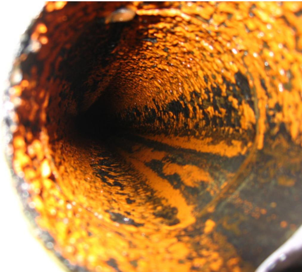
Bild 12. Ausgebildete Ablagerungen in der Kreislaufanlage aus Stahl, DN80.
