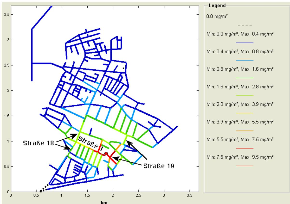
Bild 69. Ablagerungsbildung durch am Wasserwerk eingetragene Partikel innerhalb eines Tages. Roter Punkt: Wasserwerk. Korrosion hier nicht berücksichtigt.
