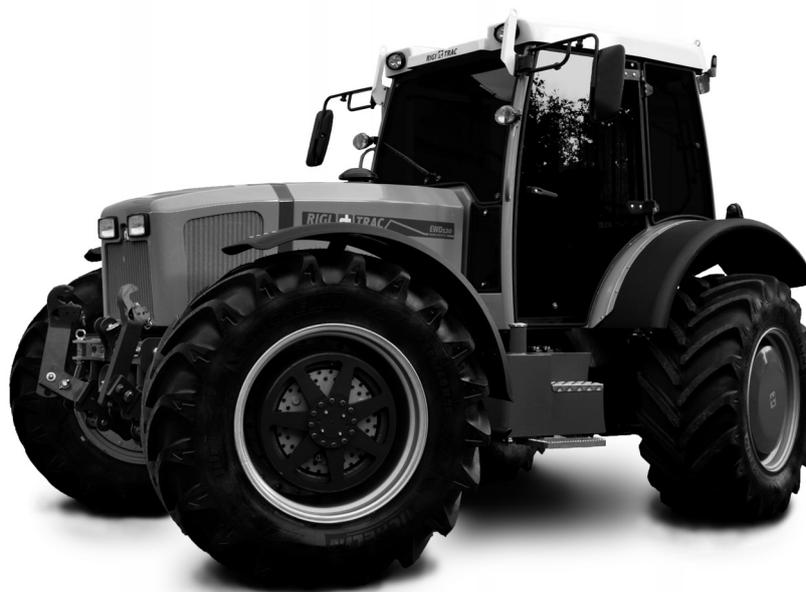
Abbildung 5.1: Rigitrac EWD 120 - Realisiertes Versuchsfahrzeug mit Einzelradantrieb und dieselektrischem Antriebsstrang
