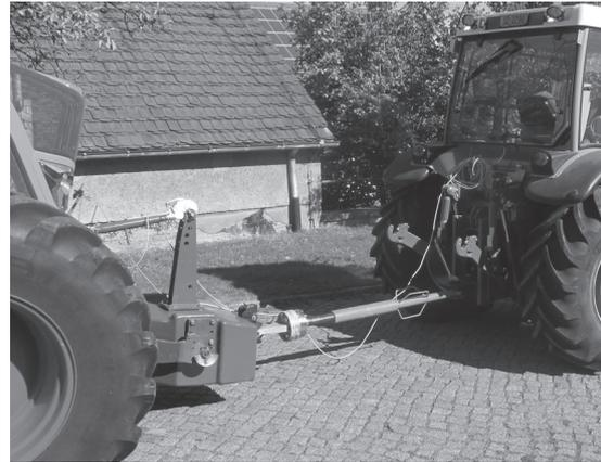
Abbildung 5.16: Fahrzeug auf dem stationären Prüfstand (a) und bei Zugversuchen (b)
