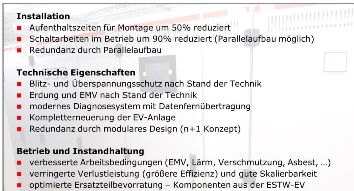
Abb. 7-4: Vorteile der modularen KEV
