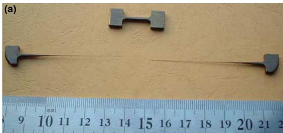
Abb. 2.11: Eine um 1624 % superplastisch verformte Probe der Legierung  $\text{Zr}_{41,25}\text{Ti}_{13,75}\text{Ni}_{10}\text{Cu}_{12,5}\text{Be}_{22,5}$  (at. %) [Wan05]
