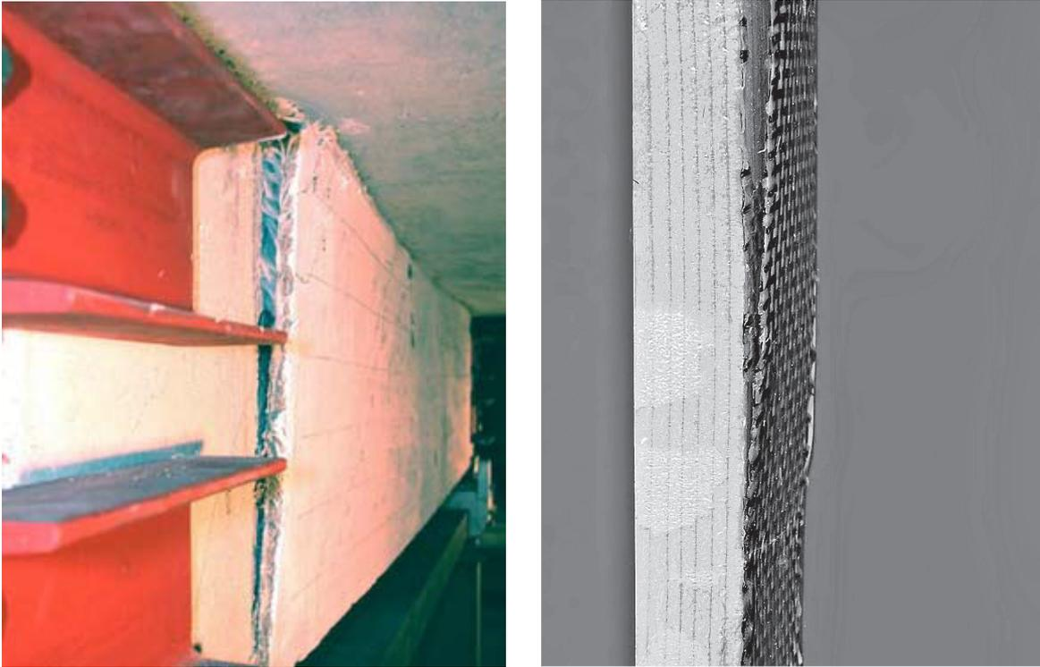
Abbildung 3.3: Delamination; links: an einem textilbewehrten Stahlbeton-Plattenbalken, rechts: an einer textilbewehrten Holz-Leiste
