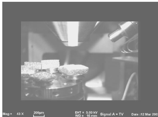
**Abbildung 1.** Schaumstoffproben unter dem REM-Mikroskop
