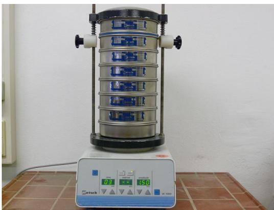
Abb. 56: Siebmaschine mit den verwendeten Sieben für die Korngrößenanalyse
