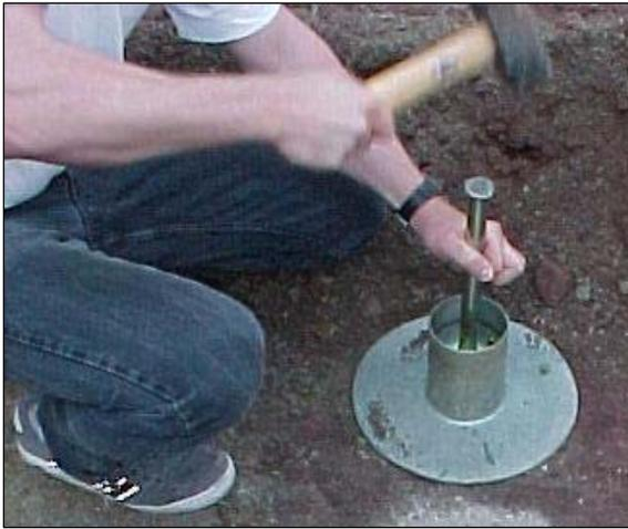
Bild 5.3: Einschlagen des Probenzylinders
