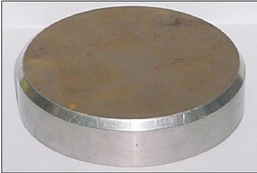
Bild 7.41: Oedometerring vor Einbau
