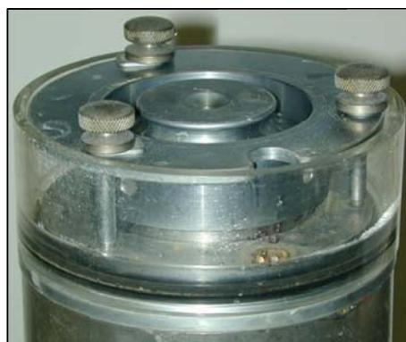
Bild 7.6: Oedometerzelle mit Bodenprobe im Triax
