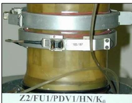
Bild 7.9: Radialsensoren an Probe
