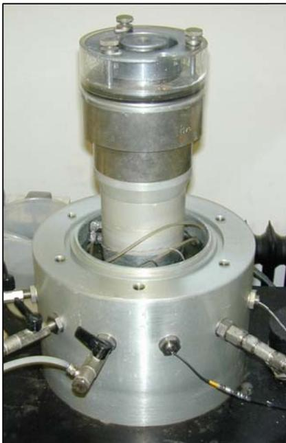
Bild 7.5: Für Oedometer umgebauter Triaxversuch
