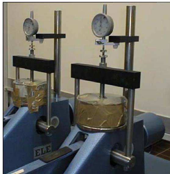
Bild 7.2: Mit Folie eingepackte Probezelle
