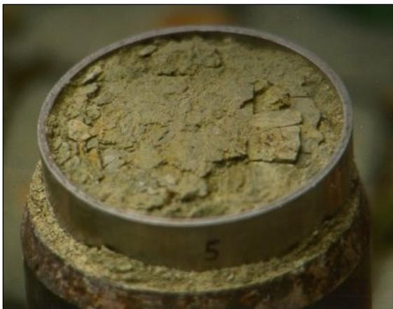
Bild 1: Einpressvorgang in Oedometerring
