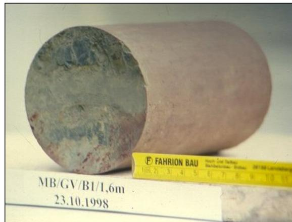
Bild 2: Probe vor dem Einbau ins  $K_0$ -Triaxgerät
