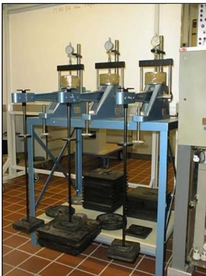
Bild 7.1: Oedometerstand im Labor für Geotechnik
