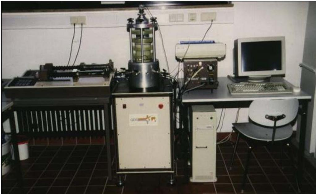
Bild 7.8: Computergesteuerte Triaxialanlage (Gesamtansicht)
