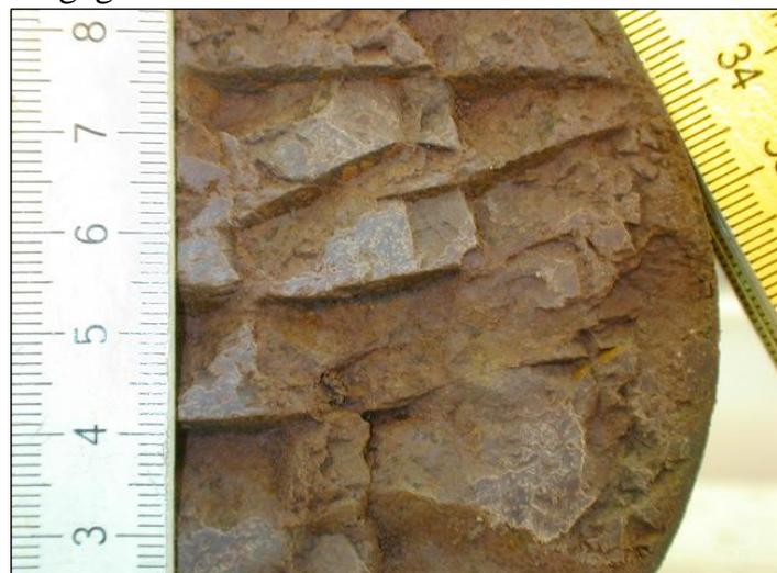
Bild 7.44: Unebenheiten der Stirnseite einer Probe
