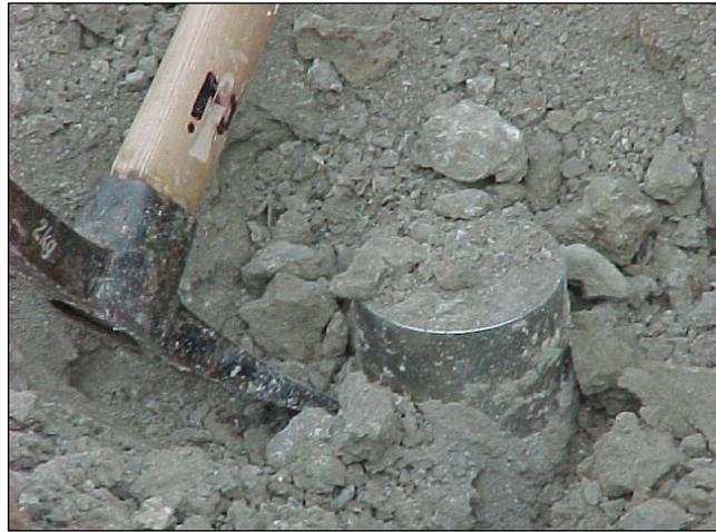
Bild 5.4: Ausgraben des Zylinders mit Probe
