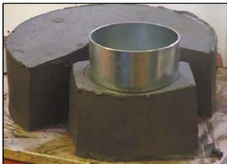
Bild 7.48: Opalinustonkuchen, mit Ausstechzylinder für  $K_0$ -Probe
