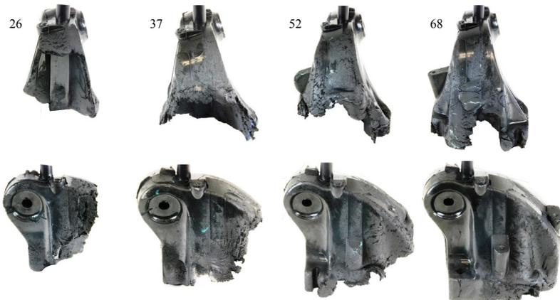
Bild 4.8: Formfüllverhalten PF1110 im Bauteil, die Zahlen entsprechen der gravimetrischen Füllung
