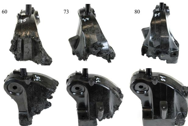
Bild 4.9: Formfüllverhalten 9202 L5-A im Bauteil, die Zahlen entsprechen der gravimetrischen Füllung
