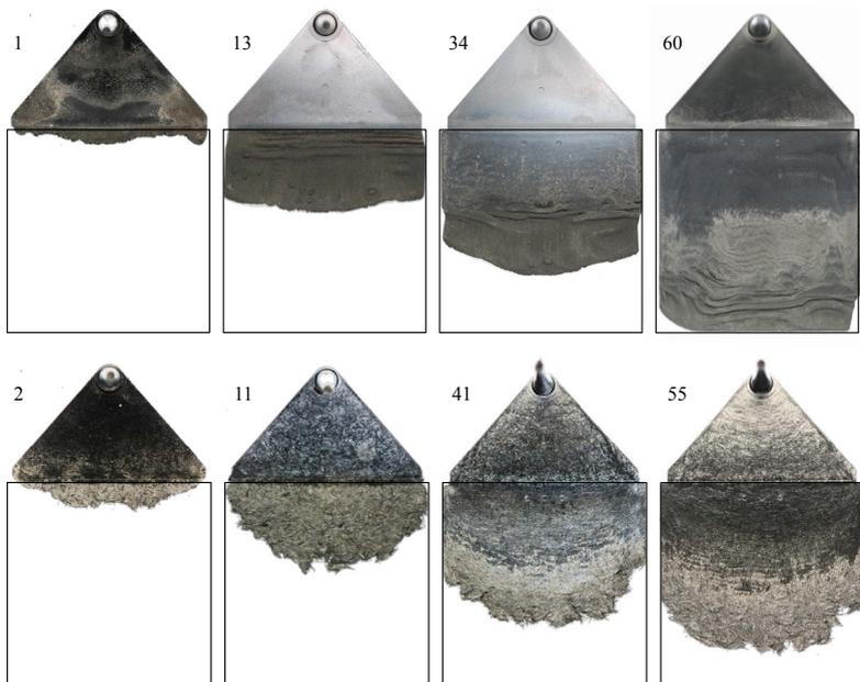
Bild 4.3: Formfüllverhalten der Platte von PF1110 (oben) und 9202 L5-A (unten), die Zahlen entsprechen der gravimetrischen Füllung ohne Anguss in %
