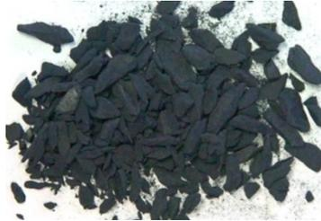
Bild 3.2: Phenolharz-Granulat Bakelite® PF 1110, Hexion Inc.
