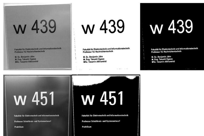
Abbildung 4.6.: Umwandlung Grauwertbild in binäres Bild durch Otsu-Thresholding. In der oberen Reihe erfolgt aufgrund weißer Eckpunkte anschließend eine Invertierung
