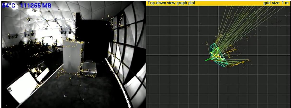
Abbildung 2.3.: links: Gelbe Punkte zeigen die erkannten Features, rechts: relative Position wird mit gematchten Features berechnet und visualisiert (aus Google I/O 2016, Quelle: Youtube)
