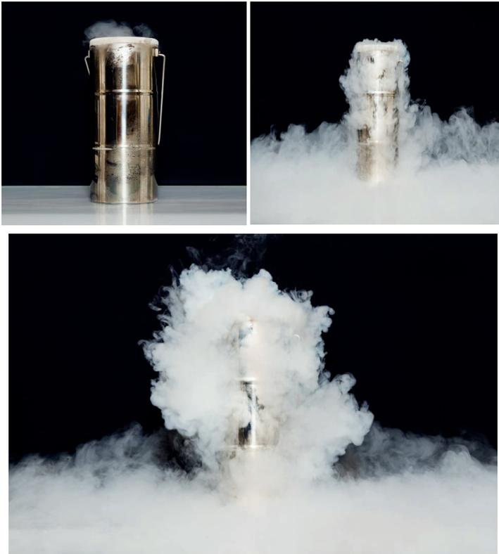
**Abb. 1.** Dewargefäß (oben links) und Verdampfen von Flüssigstickstoff ( $-196\text{ °C} \rightarrow 25\text{ °C}$ ) (oben rechts und unten).
