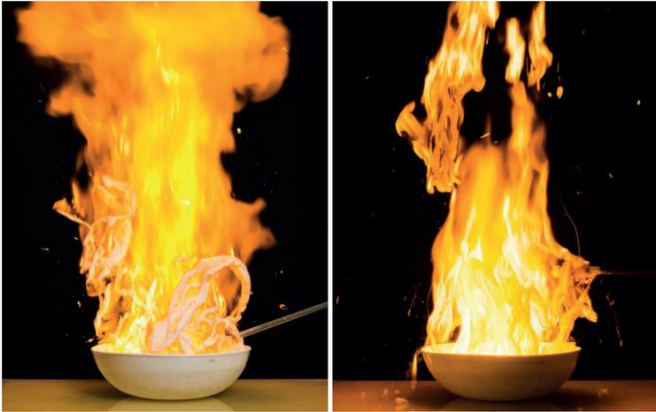
**Abb. 3.** Reaktion von flüssigem Sauerstoff mit Watte.
