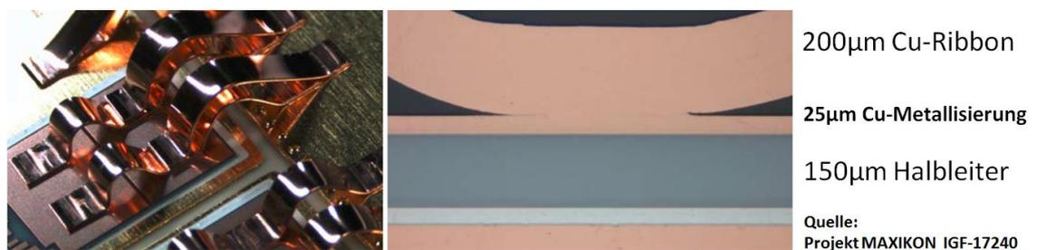
**Abb. 4-16: 200µm starke Cu-Ribbons Quelle: [46]**
