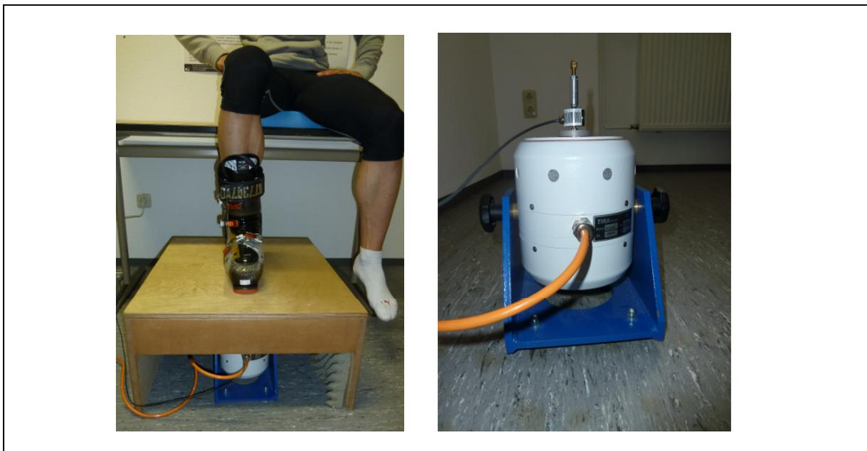
Abb. 42: Messplatz der Fußsensibilitätsmessung, li. Messplatz gesamt, re. Vibrationserzeuger TV 51075 der Firma TIRA® (eigene Aufnahmen)
