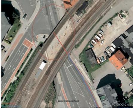
Abbildung 4: Prädiktion einer Positionslösung unter eine Brücke (rot), bei der die normale Lösung mit Least-Squares (blau) keine Position aufgrund fehlender Sichtbarkeit zu ausreichend vielen Satelliten berechnen kann. Neben der Möglichkeit einer Positionsangabe liefert das Filter ebenfalls eine Unsicherheit, was als Ellipse dargestellt wird.
