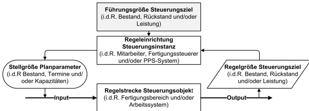
Abbildung 13: Modell der Fertigungsregelung
