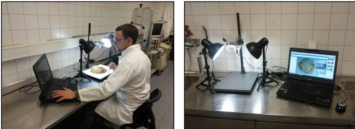
Abb. 21: Aufbau Fotodokumentationsarbeitsplatz
